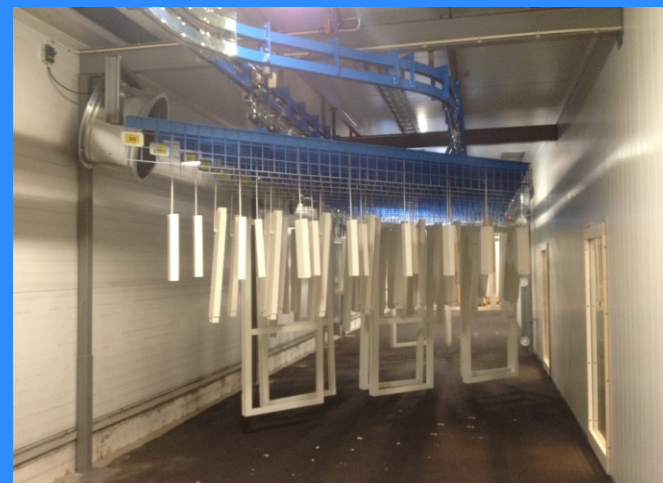
Højeffektiv tørreovn med 3 temperatur zoner
