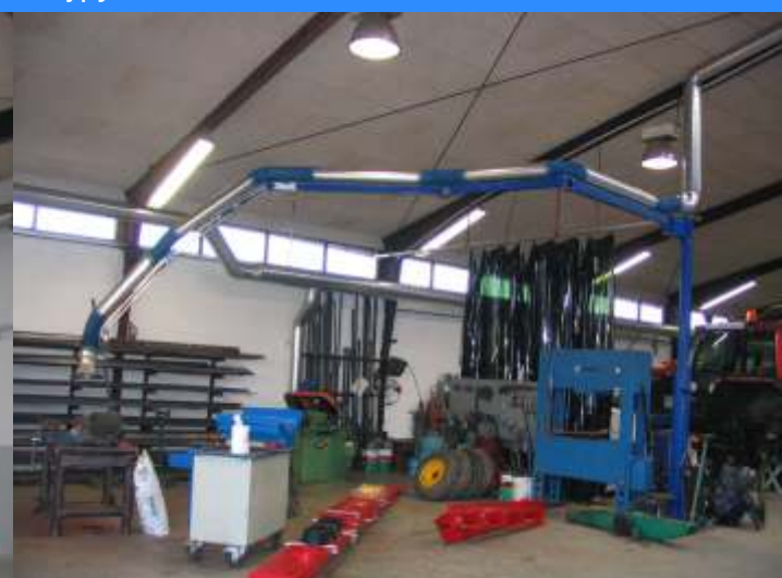
8m, sugearm monteret frit i rummet på ekstra høj pylon
