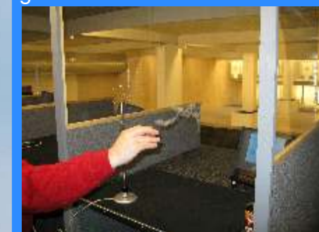
På billedet ses, hvorledes røgen suges væk fra skyttens ansigt.
